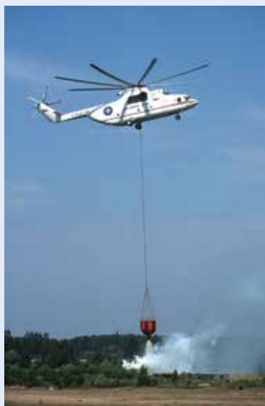
Вертолёт Ми-26 с ВСУ-15 в режиме пожаротушения
