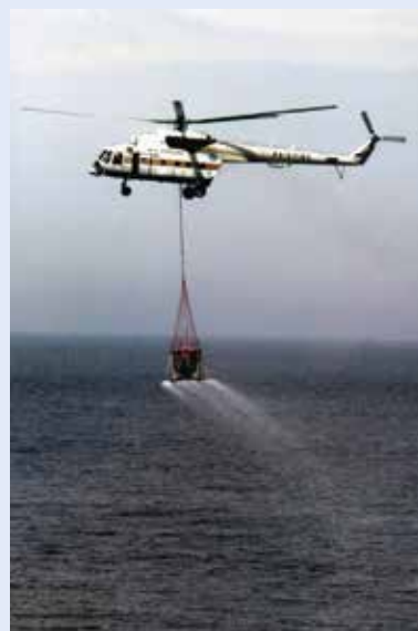
Вертолёт Ми-8 с ВОП-3 в режиме пожаротушения
