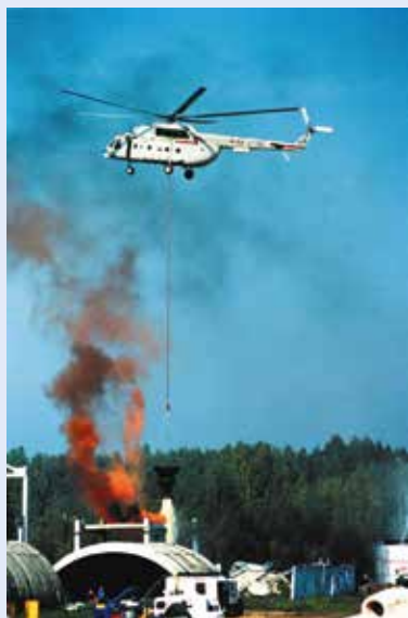
Вертолёт Ми-8 с ВСУ-5 в режиме пожаротушения
