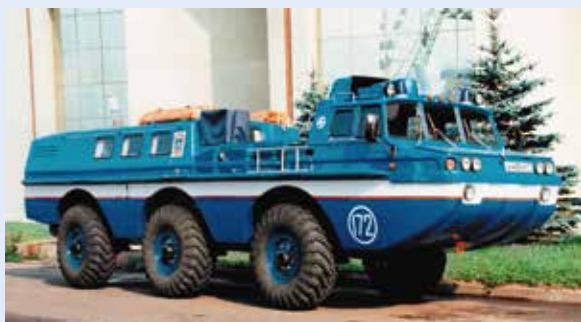
Поисково-спасательная пассажирская машина ПСМ-1П
